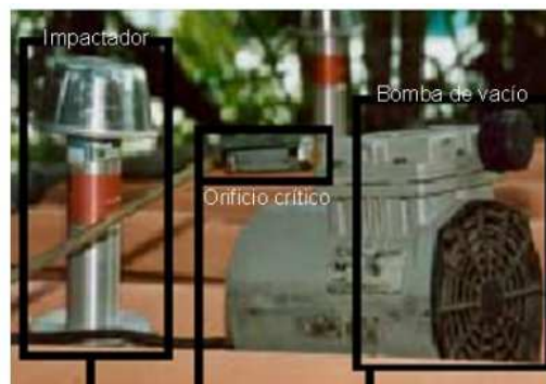
Equipo de muestreo "Harvard" / PM 10 a 10 / LPM
